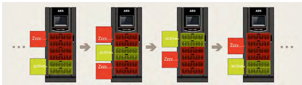
При необходимости может быть активирована попеременная работа силовых модулей в режиме ожидания.
